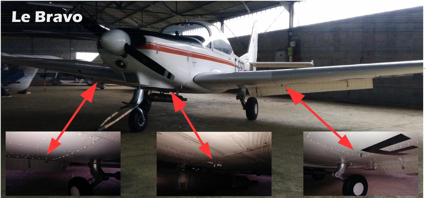
La majorité des avions légers dispose d'une purge par réservoir et d'une purge sur le circuit d'essence
